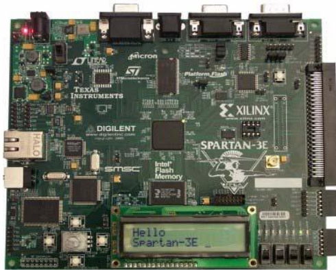
Fig. 7 Spartan 3E board
