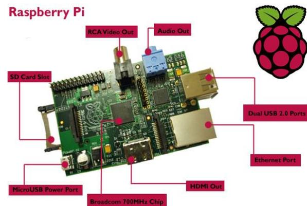
Fig 2. ON-CHIP RASPBERRY PI
